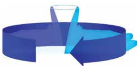
Schéma typického 2D radaru s rotujúcim anténym obrazcom
