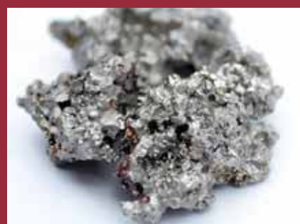
Ocelový kvet kera vznikajúci pri výrobe ocele tamahagane
