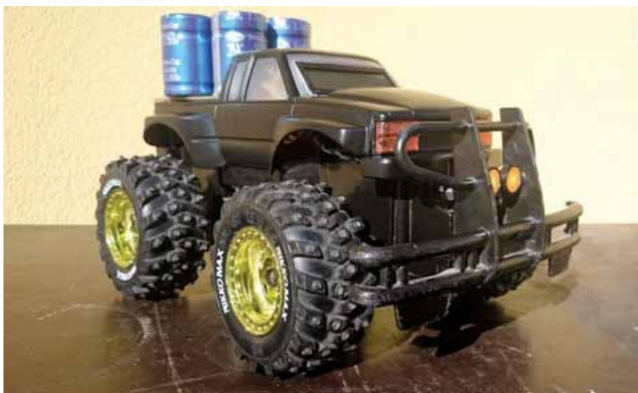
Nitrianski stredoškólači riešia reálne využitie superkondenzátora ako zdroja pre elektromobily. Zatiaľ je to v malom, ale funkčnom modeli autíčka na diaľkové ovládanie.
